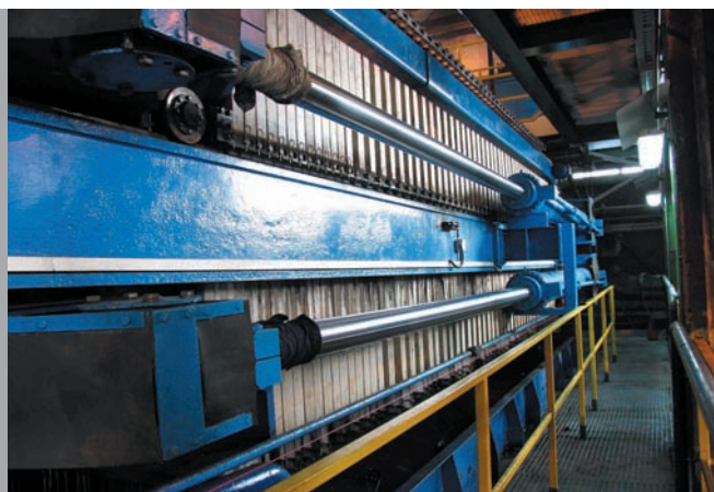
Фильтр-пресс SALA с мембранными и комбинированными камерными плитами 1500 x 1500 мм.
