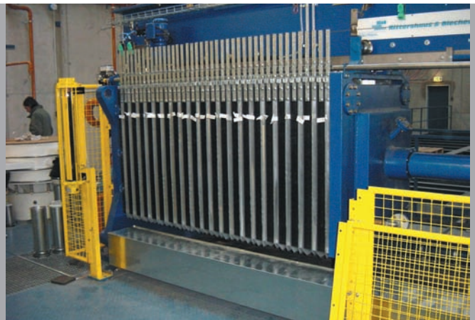
Фильтр-пресс с мембранными и комбинированными камерными плитами 1200 x 1200 мм. Фильтрация металлопигментов с растворителями
