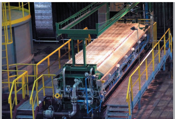
Фильтр-пресс с мембранными и комбинированными камерными плитами из PVDF (поливинилиденфторид) 1200 x 1200 мм.
